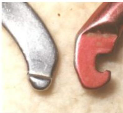
Un mousqueton de longe peut être amené à travailler en travers sur son petit axe lors d'une chute du spéléologue longé sur un amarrage. Il faut donc choisir un modèle robuste et éviter les modèles légers .
