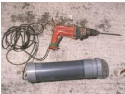
Le poids de l'accumulateur est transféré dans le sac (porté à la ceinture par exemple) ce qui donne un perforateur léger et maniable en bout de bras. L'association d'un perforateur 12 V et d'un accumulateur au plomb est particulièrement bien indiquée pour les escalades en "artif".
