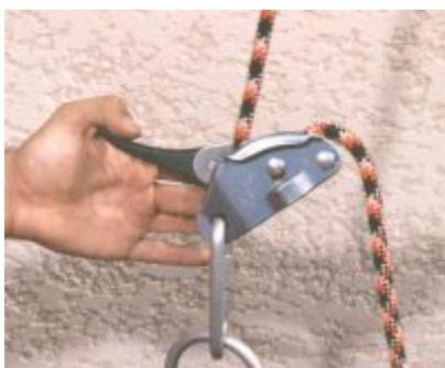
Cet appareil d'assurance conçu pour l'escalade permet d'assurer le premier de cordée sur une corde simple en dynamisant le freinage. Conçu sur le même principe que le descendeur auto-bloquant, il peut aussi le remplacer le cas échéant, pour descendre sur corde ou tendre une tyrolienne.
