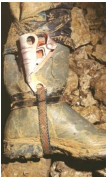
**Position haute:** le bloqueur est placé au niveau du mollet.
