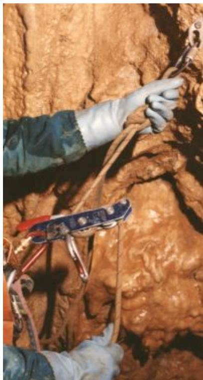
Dans les puits très étroits nécessitant de passer avec descendeur en bout de longe, il faut interdire la possibilité de blocage en introduisant un mousqueton dans le trou de la poignée prévu à cet effet. Il faut veiller à positionner ce mousqueton de telle sorte que la corde sortant du descendeur ne passe pas dedans.
