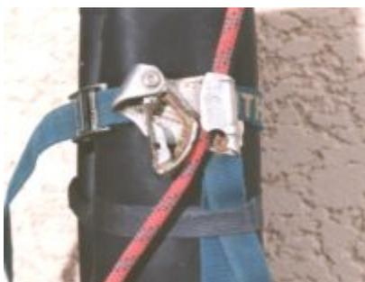
Avantage : d'un mouvement de pied on peut éjecter la corde du bloqueur, aux fractionnements, dans les puits étroits.
