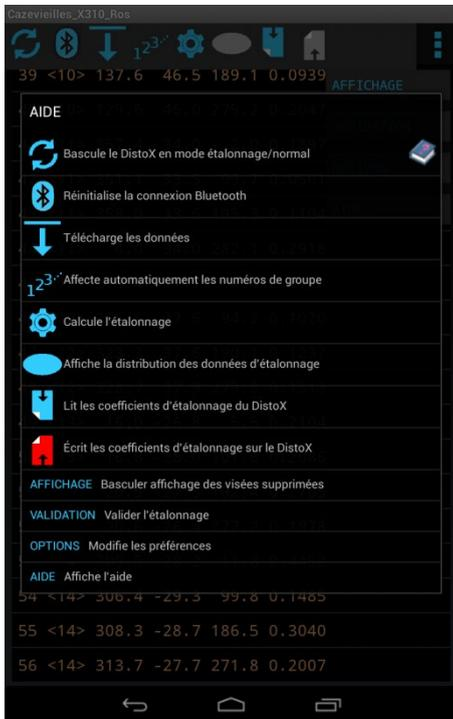
Figure 17 : Exemple de MENU / AIDE d'une des fenêtres : ici la fenêtre du tableau des données d'étalonnage. (page 35)
