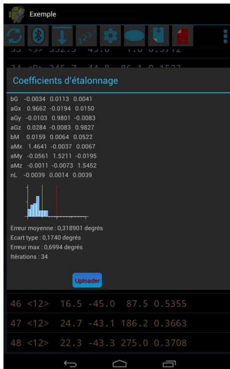
Figure 21 : Affichage des coefficients d'étalonnage (numérique et graphique) et envoi au DistoX. (page 98)
