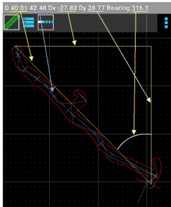
Figure 59 : Mesure d'une polyligne sur la fenêtre d'aperçu
