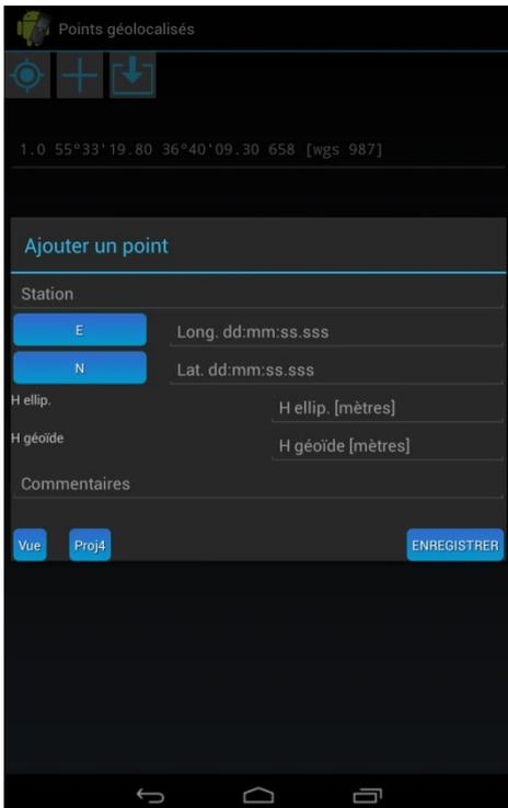
Figure 38 : Ajout d'un point aux coordonnées relevées par géolocalisation (GPS). NB : long. Est / lat. Nord. (page 106)
